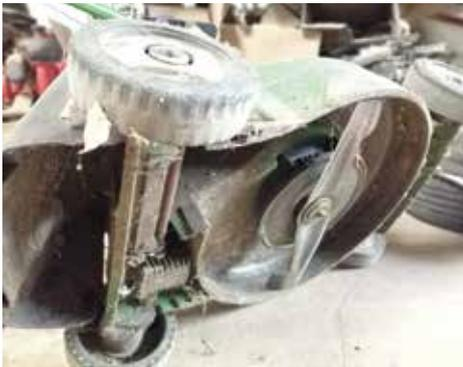
Um nach der Winterpause für einen reibungslosen und sicheren Einsatz des Rasenmähers zu sorgen, sollten folgende Punkte beachtet werden: Unabhängig von der Antriebsart ist eine Kontrolle auf Beschädigung oder lose Teile: Räder, Schneidgarnitur, Lenkstange, Gashebel etc. notwendig. Mäher mit Verbrennungsmotor: Kontrolle des Ölstands, der Kraftstoff sollte nach dem Winter im Gerät getauscht (Qualitätsverlust) und der Luftfilter gereinigt werden.
